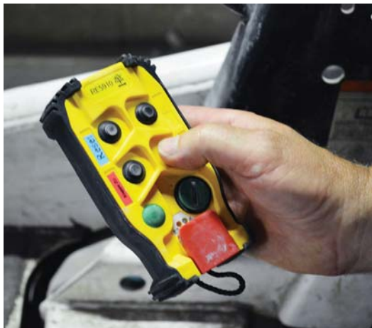
Der Bediener bestätigt auf dem Handsender das Öffnen der Klappe des Massenabwurfs.
